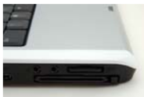
圖 3: ExpressCard 插槽共有兩種尺寸規格。做圖所示為 ExpressCard/34 插槽。而右側較寬的插槽則同時支持 ExpressCard/34 和 ExpressCard/54 模組，也稱為通用插槽。
